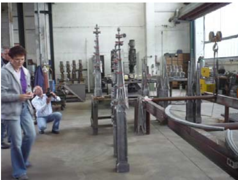
4. Werkstatttermin – Heftung der Zierelemente an den ersten Fialen zur Bemusterung
